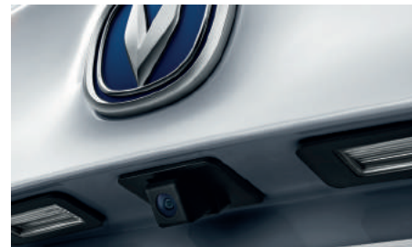
Камера заднего вида с динамической разметкой
